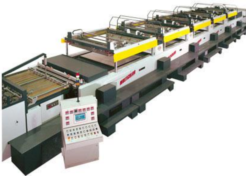
Macchina serigrafica in linea automatica di tipo modulare per stampare da 2 a 6 colori su materiali rigidi, semirigidi e flessibili.
