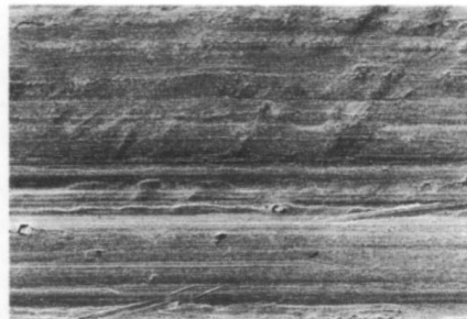
Alluminio laminato lucido: scarso ancoraggio, cattiva distribuzione dell'acqua, non adatto per la stampa.
