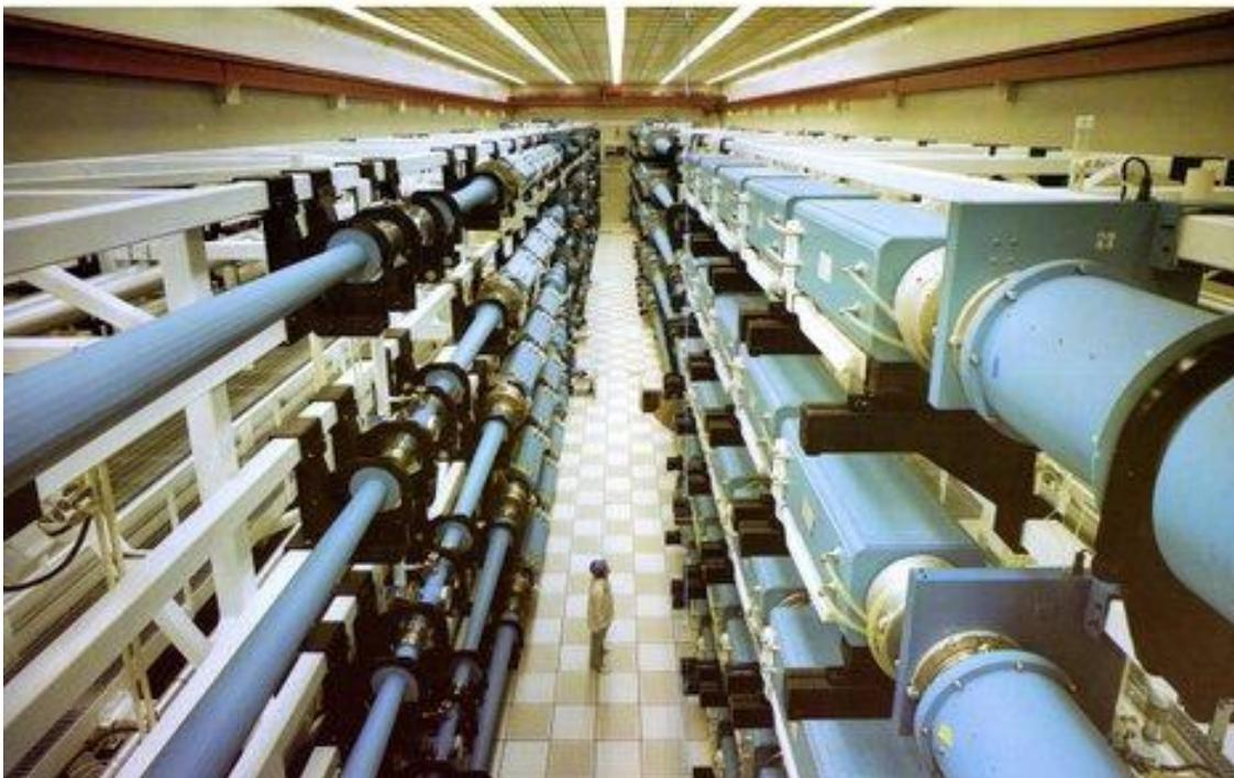
**Le dimensioni dei laser spaziano dai microscopici diodi laser (in alto), dalle numerosissime applicazioni, ai giganteschi laser neodimio-vetro (in basso), estesi quanto un campo sportivo ed impiegati per ricerche sulla fusione nucleare a confinamento inerziale ed esperimenti di fisica con altissime densità di energia.**
