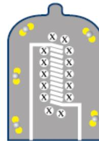
Il peso atomico più alto comporta un maggior "ingombro" della struttura atomica per cui la maglia che avvolge il filamento diventa ancora più fitta ed è più difficile per il tungsteno vaporizzato evitare la collisione con il gas che ne accelera e ne incrementa il processo di riposizionamento sul filamento.
