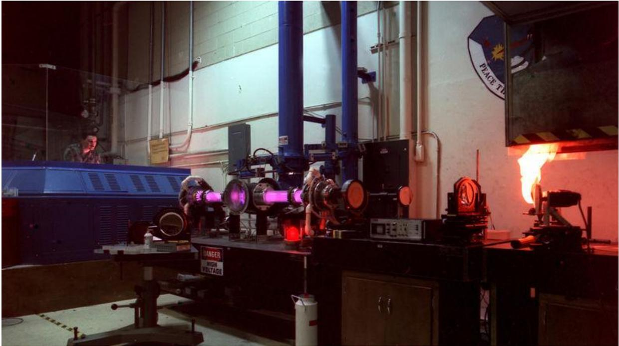
Il laser ad argon emette nella banda di 351-528,7 nm. In funzione delle ottiche e del tubo laser, sono utilizzabili differenti righe di emissione, ma le più comuni sono quelle a 458 nm, 488 nm e 514,5 nm.
