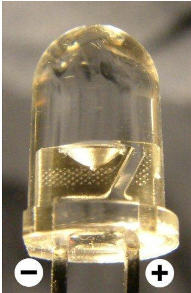
Esiste anche un metodo visivo per il riconoscimento del catodo o dell'anodo di un LED. Guardando all'interno del package trasparente si possono vedere due parti metalliche separate di diversa grandezza collegate ai terminali; la parte più grande è sempre collegata al catodo e, di conseguenza, la più piccola all'anodo (+).
