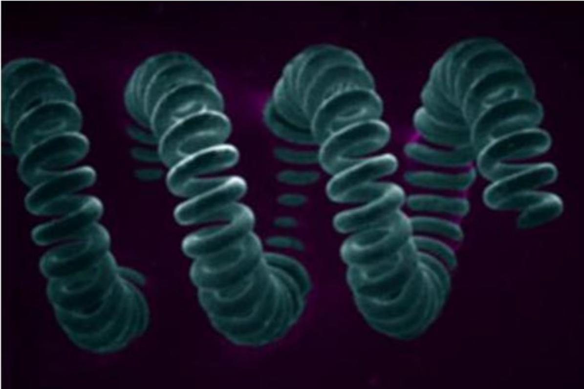
Per incrementare l'efficienza della lampada, il filamento è costituito da un sottilissimo filo accolto a spirale. Ad esempio, una lampada da 60 W ha un filamento che, disteso, raggiunge una lunghezza di 600 mm ed ha un diametro di 0,050 mm.
