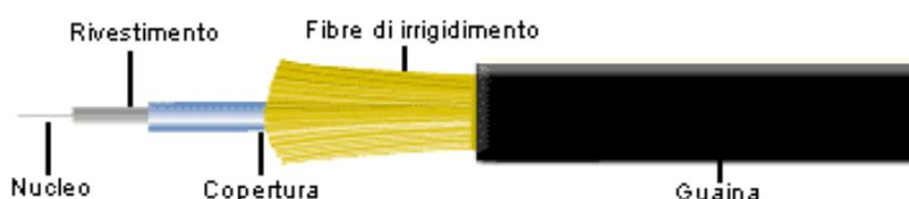
Le parti che hanno un ruolo primario nel funzionamento della fibra ottica sono, senza dubbio, il core e il cladding. Il materiale di cui è composto il nucleo ha un indice di rifrazione  $n_1$  maggiore dell'indice di rifrazione  $n_2$  del materiale componente il cladding.
