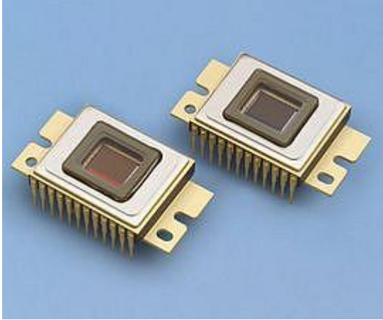
CCD monocromatico/a colori Frame Interline Transfer Texas Instruments TC247SPD/TC246RGB risoluzione: 658 (H) x 496 (V) pixel pixel: 10 \mu\text{m} (H) x 10 \mu\text{m} (V)
